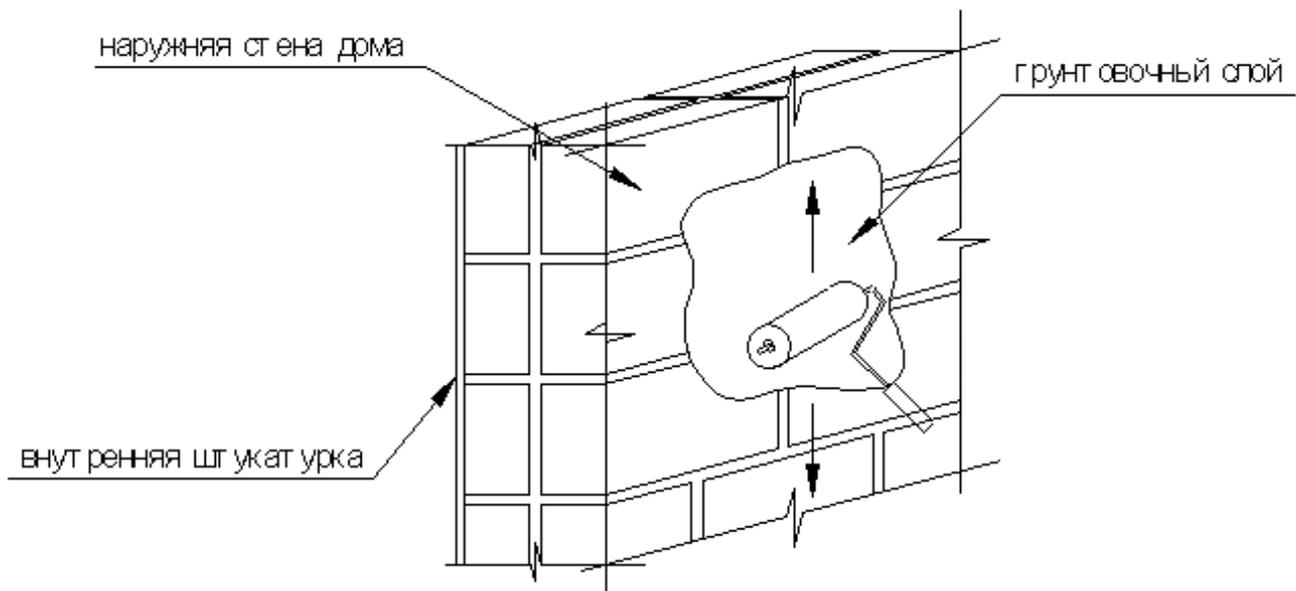
Рис. 8. Нанесение грунтовки на наружную поверхность стены
