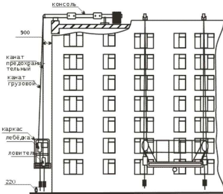
Рис. 7. Схема крепления строительной люльки на кровле
