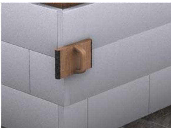
Рис. 15. Наклейка утеплителя в углах
