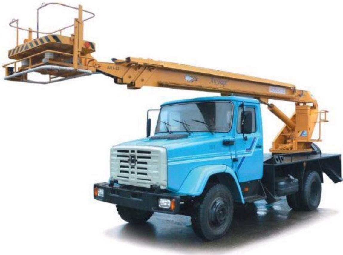
Рис. 3. Автогидроподъёмник
